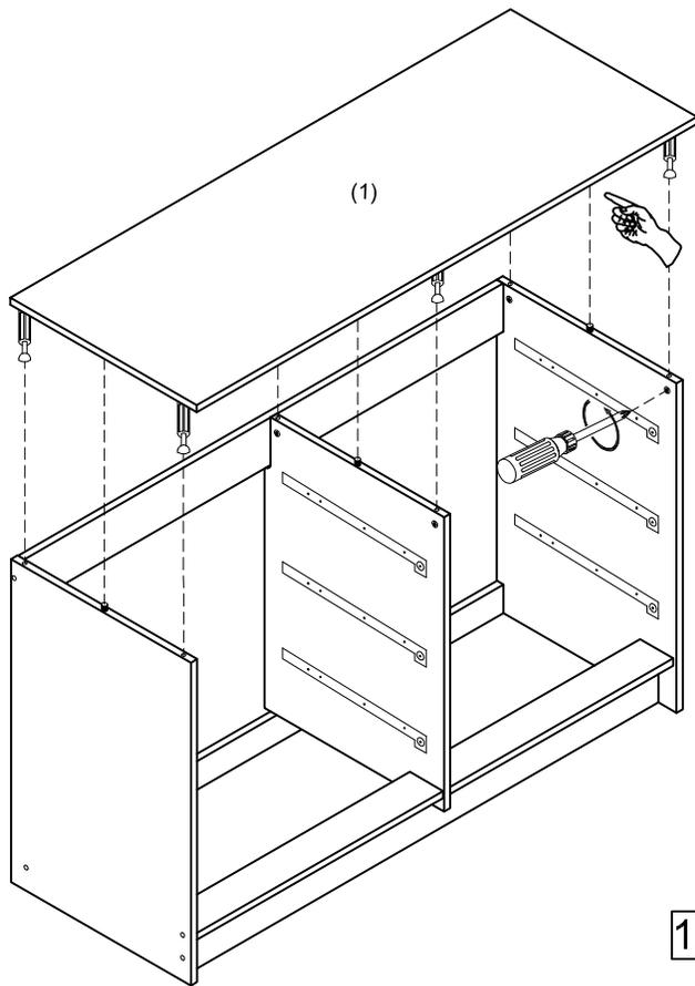
**11** Instale la cubierta (1) sobre los 3 costados, haciendo coincidir tarugos y pernos en sus respectivas perforaciones.
